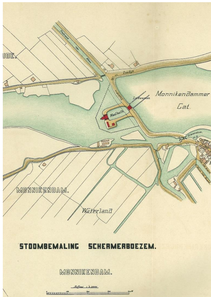
Ontwerp voor een stoomgemaal aan de Nieuwendam als onderdeel van de Schermerboezem (1896).
